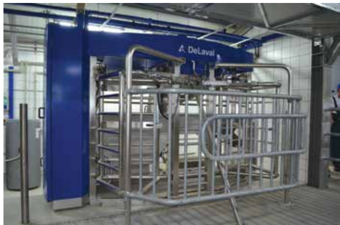
A robot 'tehenoldali' része. A masszív szerkezet a tehenek optimális fejését és abrakhoz jutását szolgálja.
