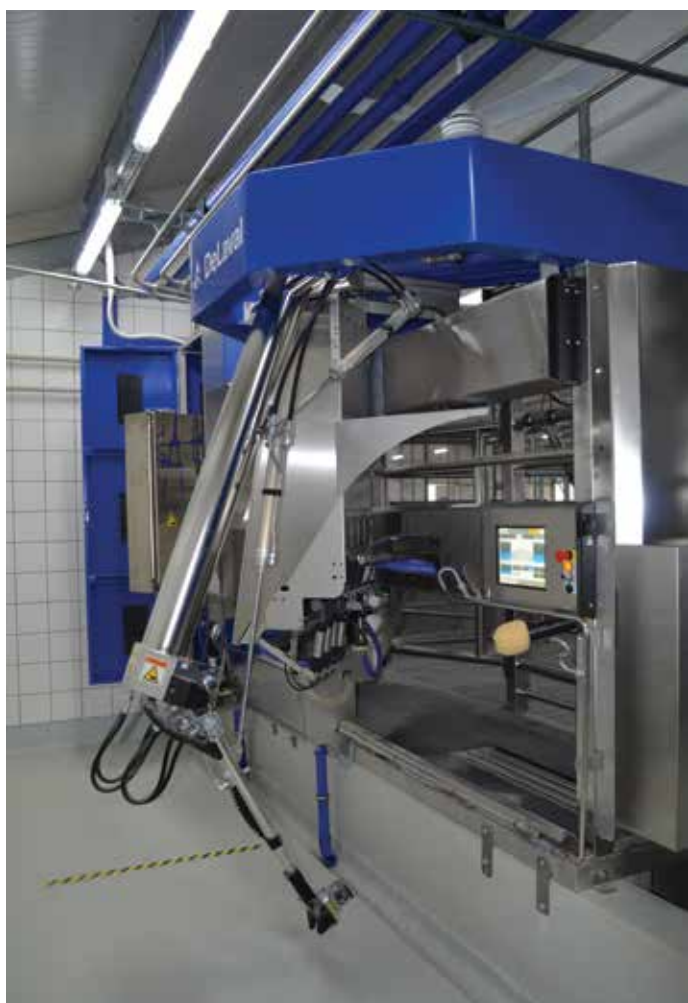
És maga a robot. 4x2-es elrendezésben 8 ilyen egység szolgálja ki a teheneket.
