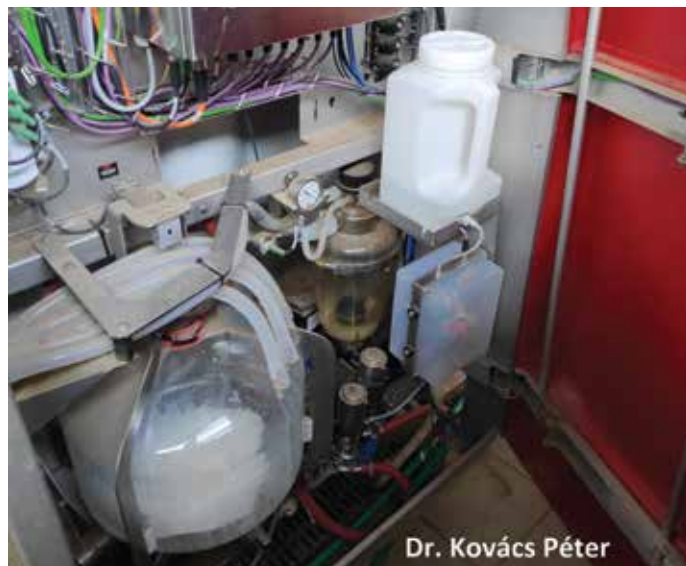
Az ún. automatizált CMT vizsgálat során a tej viszkozitásának változásából lehet következtetni a szomatikus sejtszámról
